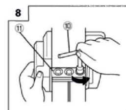
**Для установки режущего лезвия (для двустороннего лезвия)**
