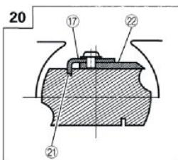
Установите режущее лезвие так, чтобы острие режущего лезвия выступало 1 мм за поверхность режущего блока. рисунок 21
