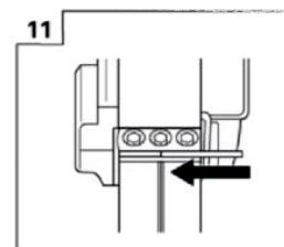
Завинтите болт на держателе режущего лезвия, как показано на рисунке 12, после того, как режущее лезвие будет заменено. Поверните головку резца и закрепите другую сторону тем же способом.
