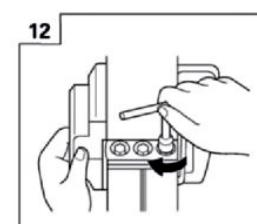
**Для установки высоты режущего лезвия (для двустороннего лезвия)**
