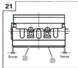
Установите держатель лезвия на инструмент и закрепите его 3 болтами, как показано на рисунке 22. Следите за тем чтобы болты были надежно затянуты.
