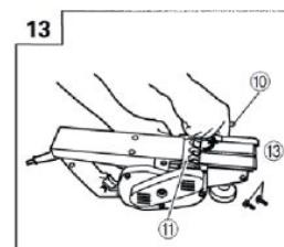
После удаления режущего лезвия с твердосплавной пластиной потяните установочную пластину, как показано на рисунке 14, в направлении стрелки, чтобы ее вытащить.
