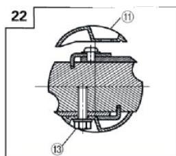
**Для установки высоты режущего лезвия (для острого лезвия)** Ослабьте 2 болта, которые удерживают режущее лезвие в установочной пластине.
