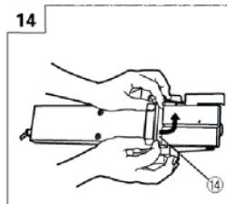
Ослабьте 2 болта, которые удерживают режущее лезвие с твердосплавной пластиной на установочных пластинах. Надавите на согнутую поверхность установочной пластины к стеновой поверхности, как показано на рисунках 15 и 16, при этом край режущего лезвия с твердосплавной пластиной должен быть направлен на стеновую поверхность установочного шаблона.
